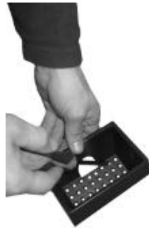
Fig. 35 - Rengöring av brännkopp
